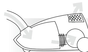
Luftführung bei Trockensauger
